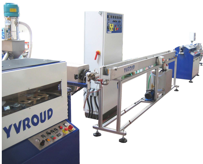
Ligne de revêtement tube de cuivre / secteur géothermie Copper pipe coating line / geothermal application
