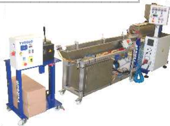
Ligne de granulation / secteur laboratoire- R&D Pelletizing line / R&D application
