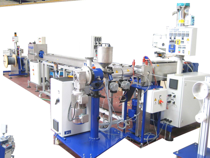
Ligne de revêtement rowing + conducteurs / secteur agricole Coating line for rowing + wires / agricultural application
